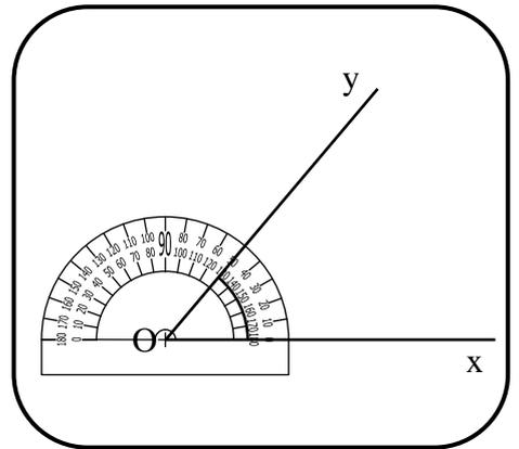
... autour de son centre jusqu'à ce que le « 0 » d'une des deux graduations (ici, la graduation extérieure) se place sur le côté de l'angle.
